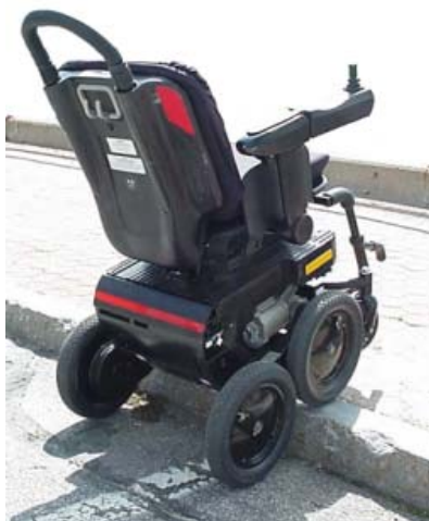
図2 4輪機能による段差越え
